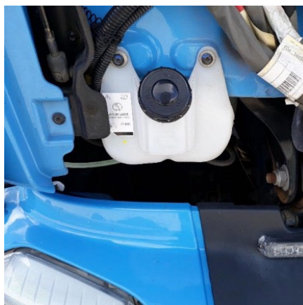
5. Sprinklerbeholder på bil
